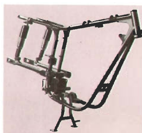
Cadre en double berceau d'une rigidité absolue. Fourche avant télescopique, suspension arrière oscillante avec amortisseurs.
