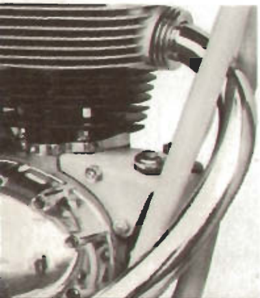
Bloc moteur fixé au cadre par des blocs en caoutchouc absorbant toutes les vibrations à tous les régimes.
